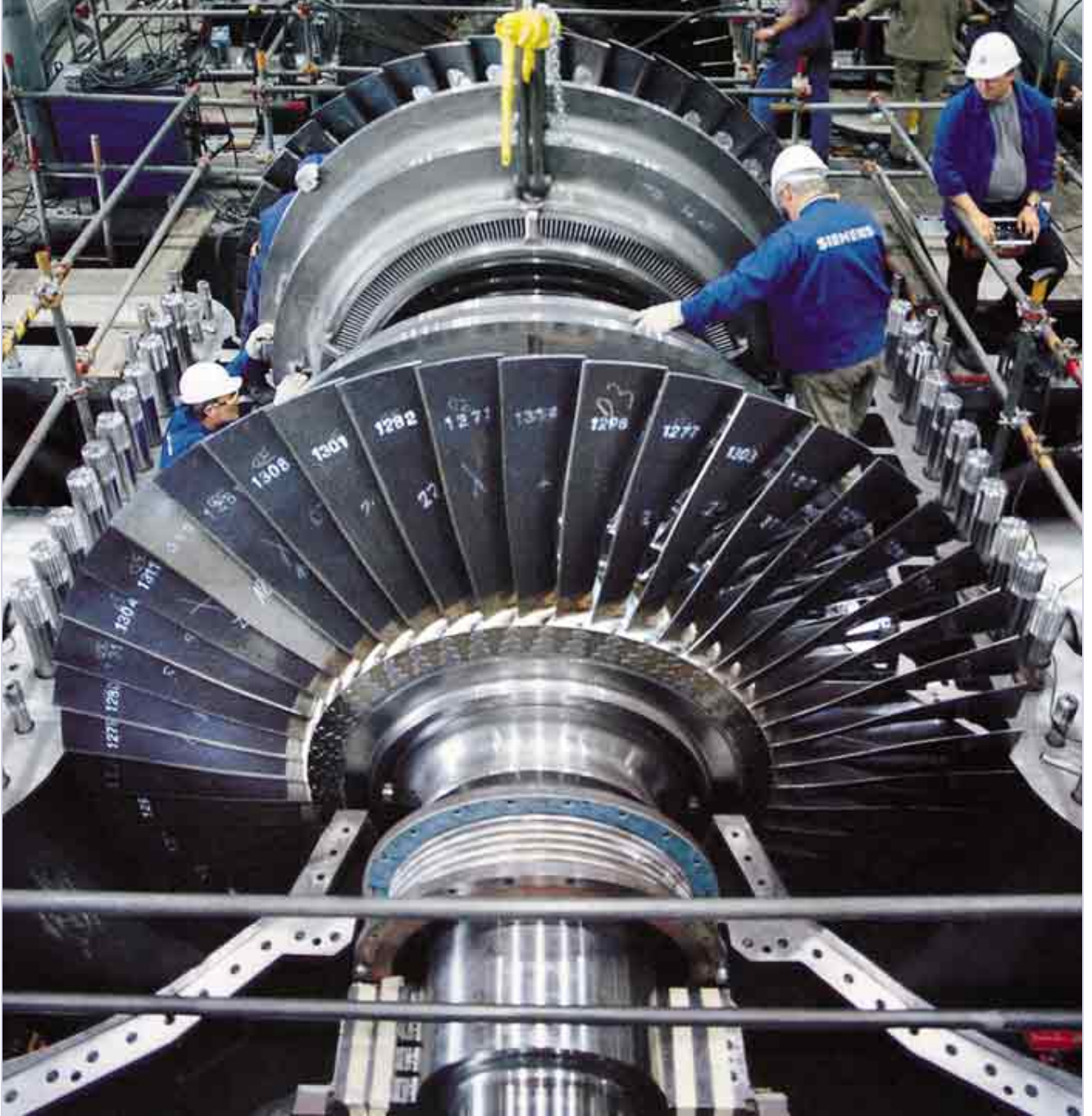
بواسطة انبوب كبير الحجم يوجه ذلك البخار الى زعانف التوربين وهي ما يقارب 42 زعنفة حسب تصميم المهندس للتوربين
